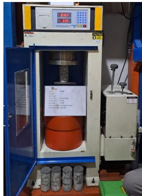
Gambar 11. Pengujian salah satu sampel beton inti Sumber: Dokumentasi pengujian di laboratorium PT. Hesa Laras Cemerlang, 2023
