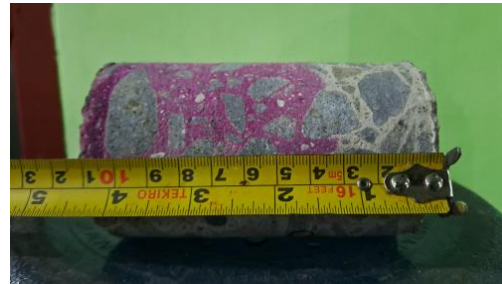
Gambar 10. Pengukuran kedalaman karbonasi sampel beton Sumber: Dokumentasi pengujian di lapangan, 2023
