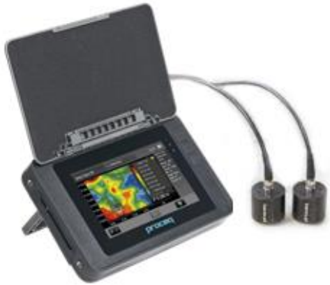
Gambar 3. Alat ukur cepat rambat gelombang ultrasonik Proceq PL200 (Proceq, 2022)
