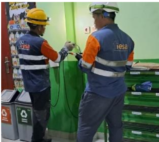
Gambar 4. Dokumentasi pengambilan data cepat rambat gelombang ultrasonik dengan direct method Sumber: Dokumentasi pengujian di lapangan, 2023
