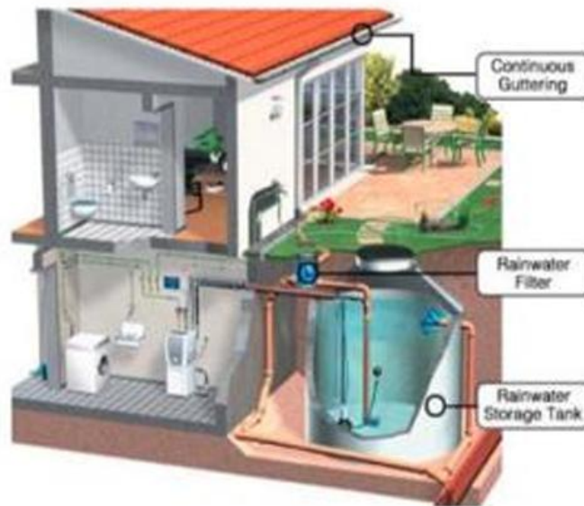
Gambar 1. Sistem Penampungan Air Hujan (PAH)
