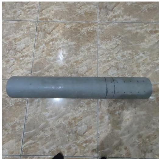
**Gambar 2** Pipa Yang Telah Diberi Lubang
