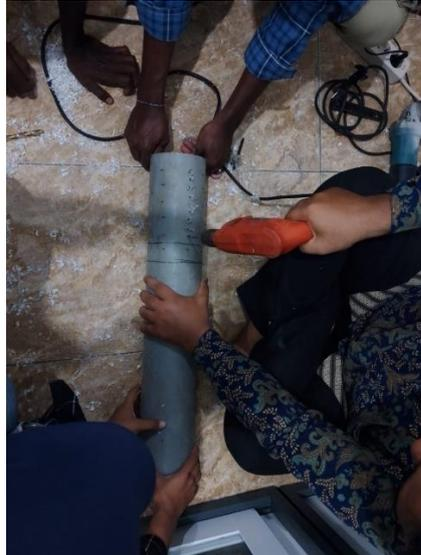
**Gambar 1** Proses Pemberian Lubang Pada Pipa
