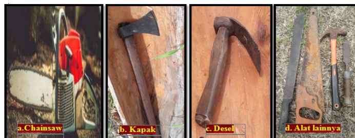
Gambar 4. Alat yang digunakan untuk Pembuatan Perahu ( Towaya )
