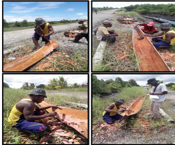
Gambar 3. Proses pembuatan perahu
